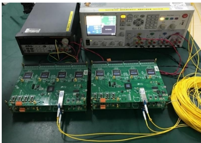
图 6. 原型电子学（4 块 FEC，合计 1024 通道）测试现场
