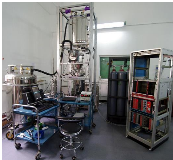
图 10. 原型电子学与液氩探测器联调现场
